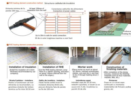
16.Instalarea cablului de incalzire
